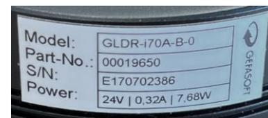
Häufig fehlt jedoch die Angabe des max. Stromes. Dieser kann dann mit der Leistung und Spannung berechnet werden:
